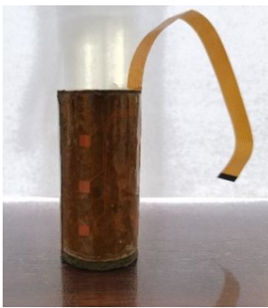
图 10 试验结束后柔性电极状态
