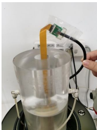
图 6 印刷电极与电缆连接
