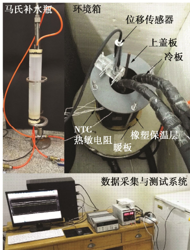
图 2 膨胀土冻胀试验系统
