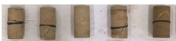
(b) 40 MPa 水压砂岩典型破坏形态 (围压 80 MPa)
