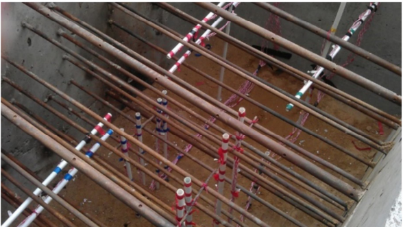
图 13 模型试验冻结方案及测点布置
