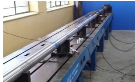
图1 SHPB试验装置
