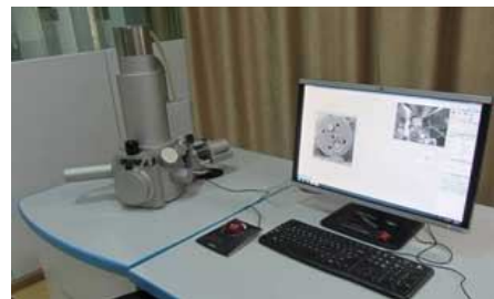
图2 JSM-6510钨丝扫描电镜
