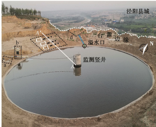
注: A—A'为图3中的监测剖面分布位置; a为雨量计和蒸发皿; b为进水阀门及水表; c为3个侧渗监测剖面; d为排水收集桶
