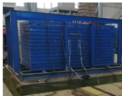
图1 剪切型模型土箱
