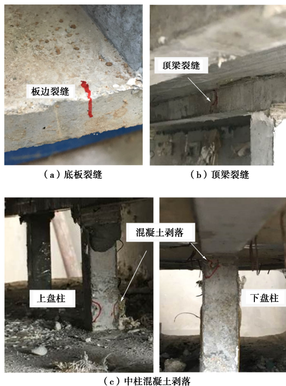
图7 模型结构破坏现象
