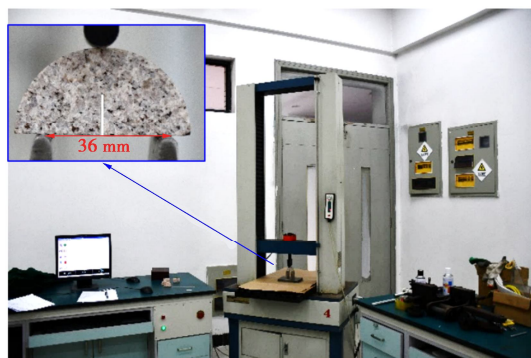
图 3 试验系统及岩石三点弯曲试验
