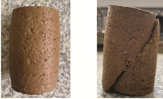
(a) 中心鼓形, s=0.2 MPa (b) 剪切破坏面, s=38 MPa 图 7 不同吸力下试样剪切后状态
