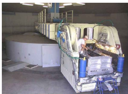
图 2 UC Davis 半径 9.1 m 大型动力离心机
