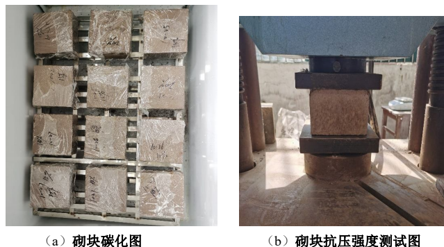
图 1 砌块碳化图及抗压强度测试图
