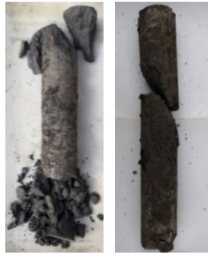
图5 水泥土桩破坏形态
