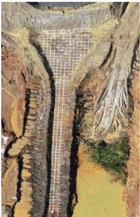
图 6 溃口演化及下泄过程记录网格 Fig. 6 Record grids of breach evolution and discharge process
