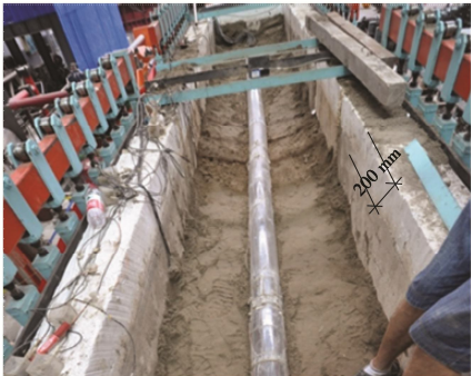
图 2 模型管道敷设示意图
