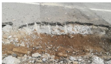
图3 公路 A（省道）K17+330 断面开裂部位路肩开挖取样
