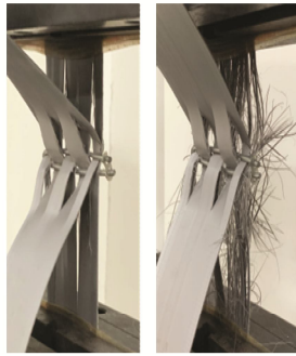
(a) PP 土工格室条带(含插接结点)拉伸试样及拉伸失效模式
