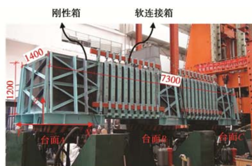
图1 三台阵振动台试验悬挂式连续体模型箱
