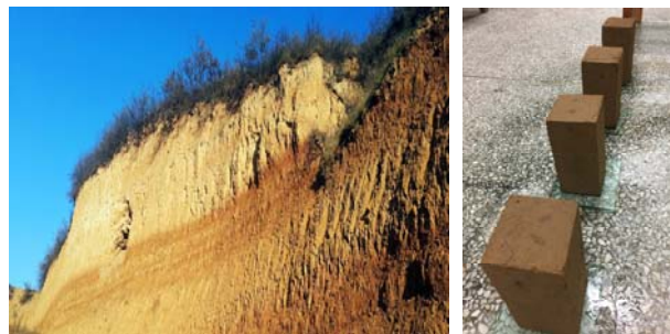
图 7 取土环境及实验室制备原状三轴试样
