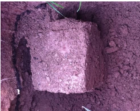
图 4 现场试验区覆盖层红黏土原状样
