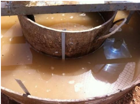
图 2 现场双套环入渗试验
