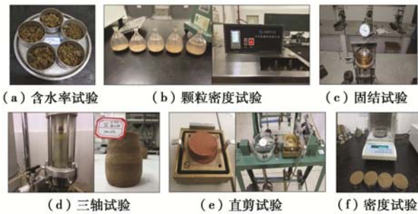
图 4 砂层及土层围岩基本物理力学试验
