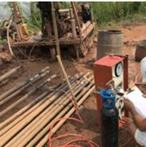
图 7 旁压试验过程照片 Fig. 7 Photos of pressuremeter tests
