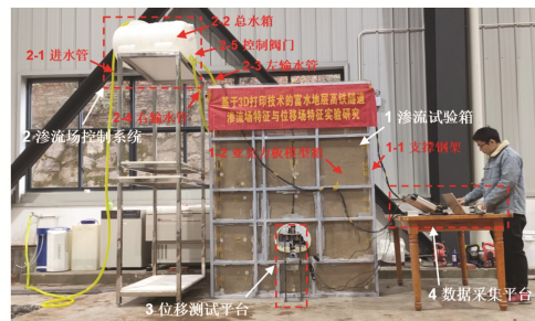
图 8 渗流试验系统及其组成
