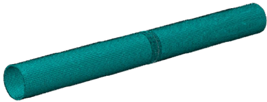
图 6 隧道结构网格划分
