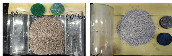
(a) 100 g/L高岭土浆液灌浆加固试样 (b) 高岭土混合加固试样
