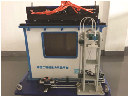
图 6 湿干冻融离心模型试验平台
