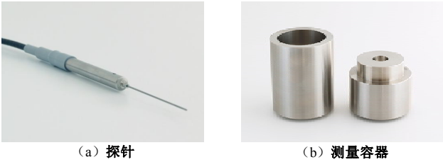
图 1 TP08 小型瞬态导热系数探针及其测量容器
