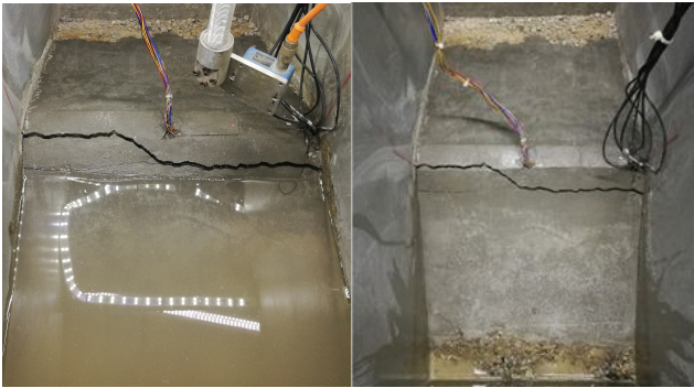
图 11 上游护坡及坝顶开裂破坏情况 (无抗震措施模型 M1)
