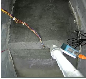
图 12 地震后的坝体 (有抗震措施模型 M2)
