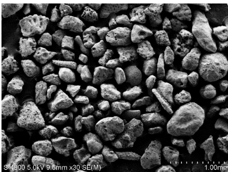
图 1 典型钙质砂颗粒的电镜扫描图片 (30 倍)
