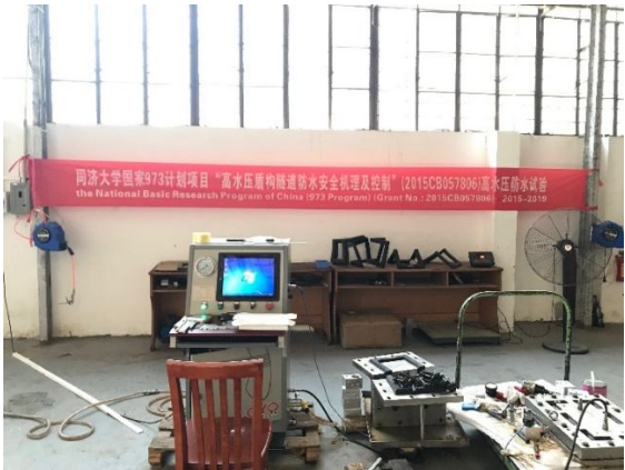
图 8 伺服式高水压接缝防水试验装置
