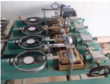
图 5 四联应变控制式直剪仪
