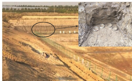
图 2 引江济淮试验段 K41+600 边坡膨胀土
