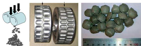
图 3 辊压法及其制备的颗粒 [7,11]
