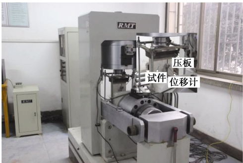
图 2 RMT-150B 岩石力学试验机
