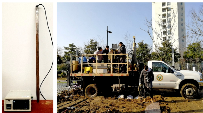
图 8 热传导 CPT 测试系统与现场测试
