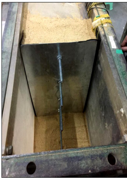
图 7 预应力返包式加筋土挡墙模型
