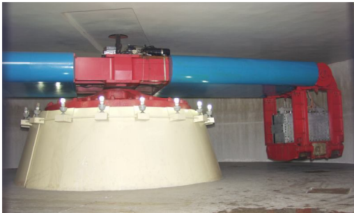
图2 NHRI 400 g-t 大型土工离心机
