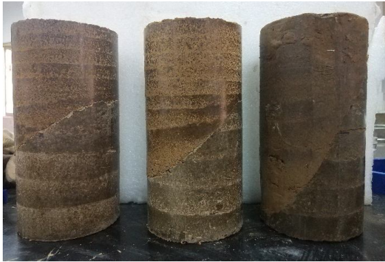
图 1 不同倾角结构面软弱夹层试样
