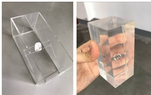
图 3 预埋-浇筑法 (模具及含薄片试样)
