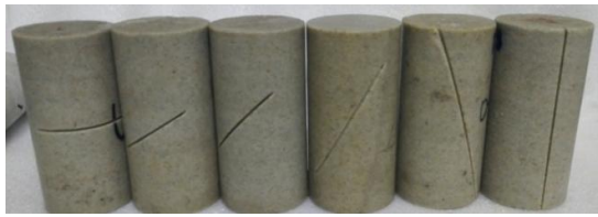
图 3 断续节理砂岩试样照片
