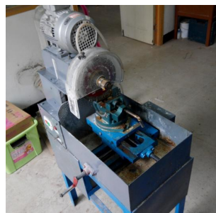
图1 自制的节理岩样切割机
