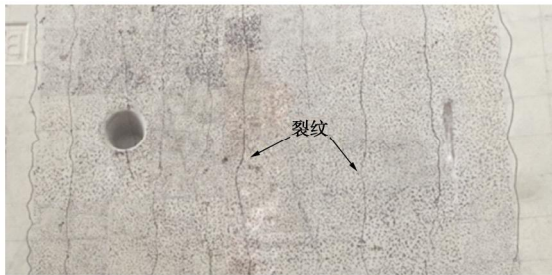
图 22 B3 块内弧面纵缝裂纹开展情况
