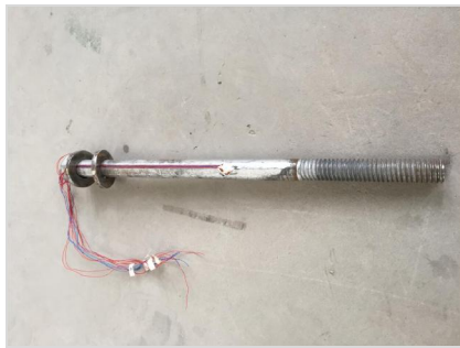
图 9 螺栓应变测点布置示意图
