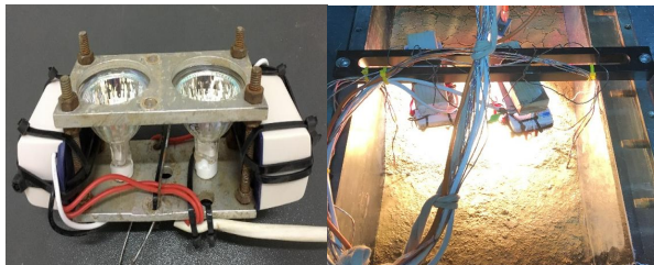
图7 用于模型干燥的光照装置
