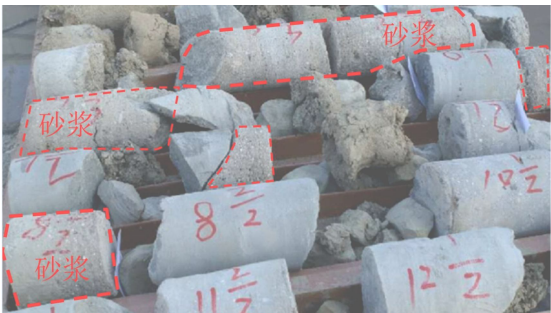
图 3 检查孔钻孔取芯照片
