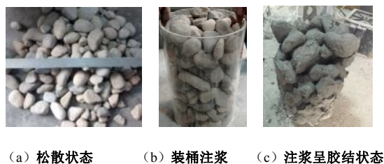
图1 控制性注浆原理及效果图
