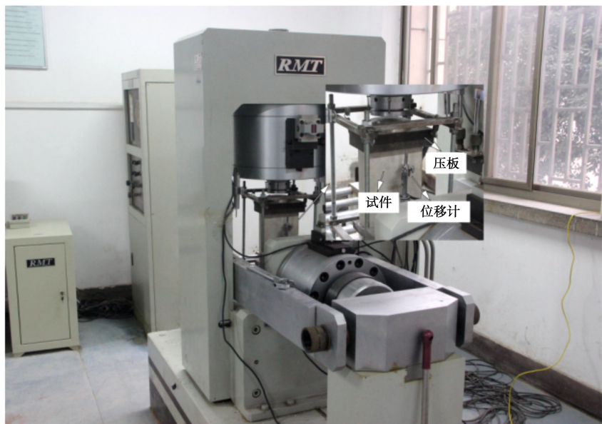
图 2 RMT-150B 岩石力学试验机 Fig. 2 Rock mechanics testing machine RMT-150B
