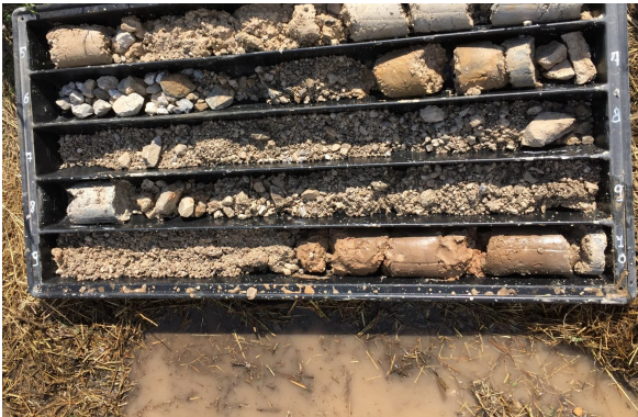
图 7 意大利 Avasinis 砾性土液化场地取样 Fig. 7 Gravelly samples collected at Avasinis in Italy
