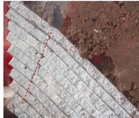
图4 45°倾角的反倾岩质边坡次生倾倒整体破坏面图
