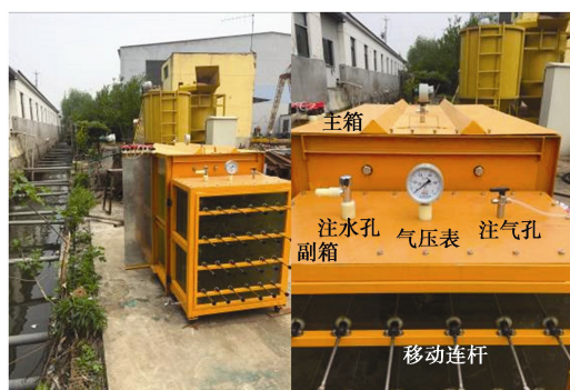
图 10 试验装置气/水密封性情况现场检验
