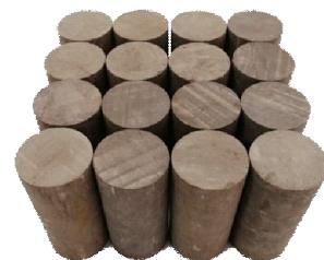
图3 红砂岩圆柱体标准试样
