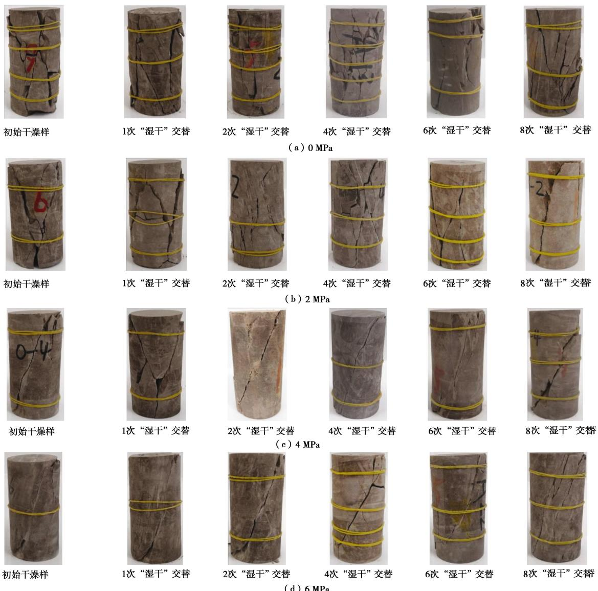
图 9 红砂岩试样的破坏模式
