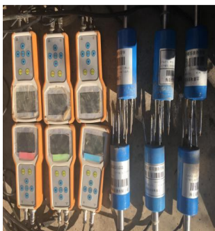
图 5 土壤水、热、盐测试仪
