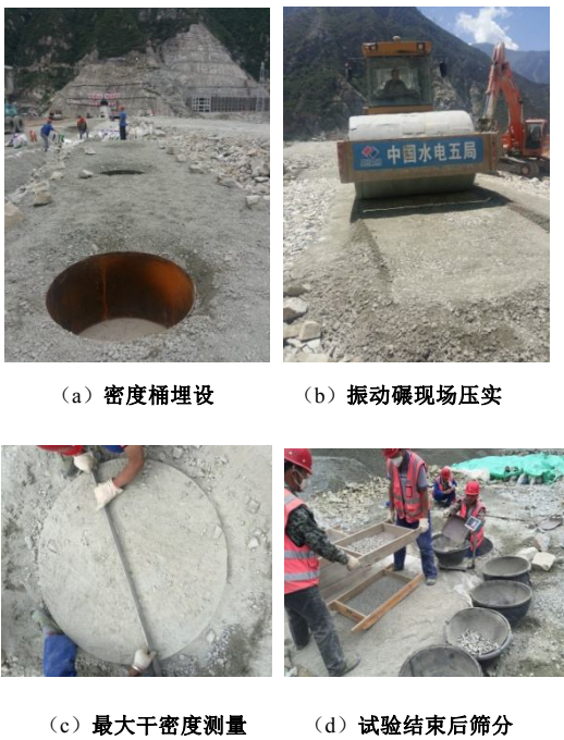
图 5 堆石料现场相对密度试验
