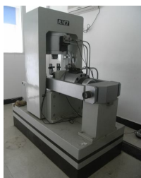
图4 RMT-150C 岩石力学试验系统
