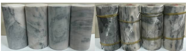
图9 破坏前后灰岩岩样照片
