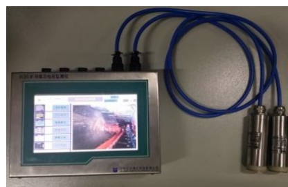
图 10 便携式电荷监测仪
